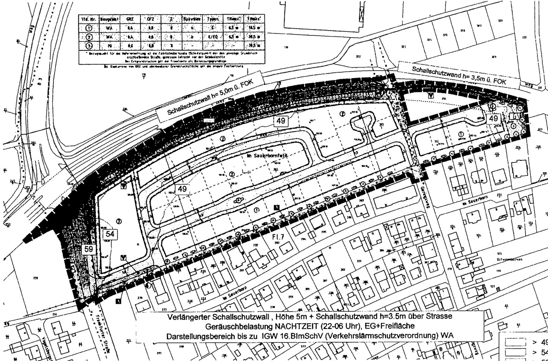
Verlängerter Schallschutzwand, Höhe 5m + Schallschutzwand h=3.5m über Straße
