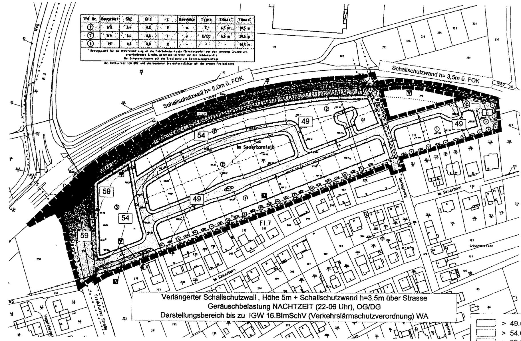
Verlängerter Schallschutzwand, Höhe 5m + Schallschutzwand h=3.5m über Strasse
